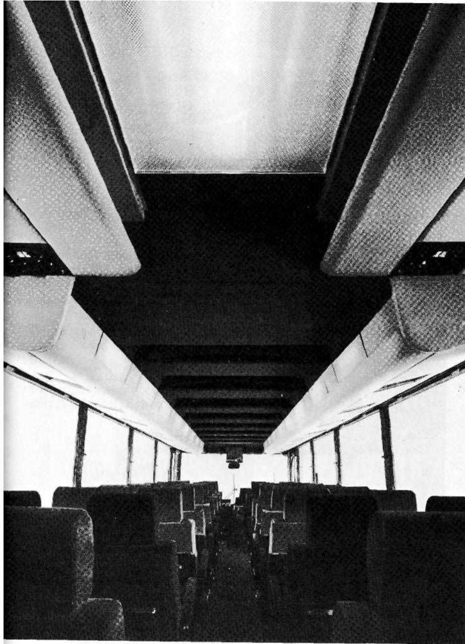
El interior del autocar donde se advierte en seguida la máxima visibilidad. El efecto túnel es anulado mediante repisas transversales y la elevación del techo en la parte posterior del vehículo
