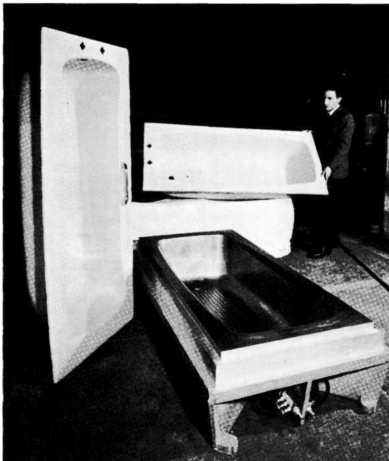
Molde de aluminio para la fabricación de bañeras obtenidas a partir de planchas de metacrilato con el procedimiento del termomoldeado al vacío
