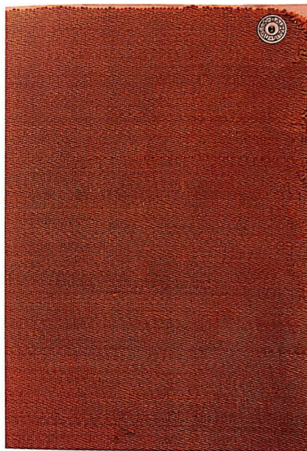
Stoffa di filo lucido di cotone molto resistente e compatta realizzata per rivestire la sedia in tubi d'acciaio. Si noti la piombatura con cui si contras-segnavano tutti i tessuti del Bauhaus.
